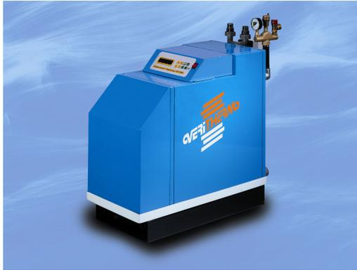
VERITHERM Voll-Brennwertkessel Typ 10, 7,5-15 kW, zweistufiger Öl-Blau-Brenner, Umwälzpumpe, Abgasgebläse, Vierwegemischer, Neutralisationsanlage mit Granulat, isolierte Kompaktverrohrung mit allen sicherheitstechnischen Einrichtungen, Heizölfilterstation, Steuerung VST 2001 Prozessorleitrechner mit Klartextanzeige und Bedienungsführung. Statistik, zwei Heizkreisen-Solarkreis- und Boilerkreisregelung. Drehzahlregelung der Pumpen.
